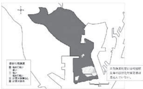
図3.6-3 理論上最大想定モデルの地震（陸側ケース）の液化化危険度
